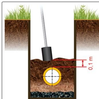
Mampatkan lapisan tanah / pasir ± 75 - 100 mm di atas bagian atas pipa. Lapisan tanah / pasir samping dipadatkan ± 75 mm antara sisi pipa dan sisi parit.
