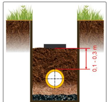
Jangan menggunakan mesin pemadat tanah sampai pipa tertutupi lapisan tanah hingga ketebalan 300 mm.
